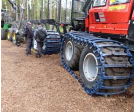
Met zogenaamde tracks die rond de banden van harvesters of forwarders worden gelegd, wordt het contactvlak met de bodem vergroot waardoor de bodemdruk van de machine daalt (foto Martijn Boosten, Probos).
