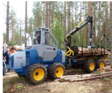
De forwarder LVS 520 van de Tjechische firma Novotný is een lichte machine met een maximale laadvermogen van 5 ton die goed kan worden ingezet bij dunningen (foto Martijn Boosten, Probos).
