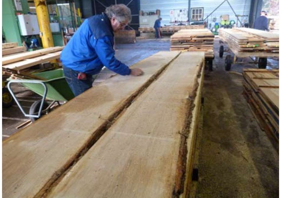
Gezaagd inlands eiken voor meubels (50 cm breed, 600 cm lang) met weinig spinthout bij Zagerij Twickel. (foto: Fons Voncken, Probos)
