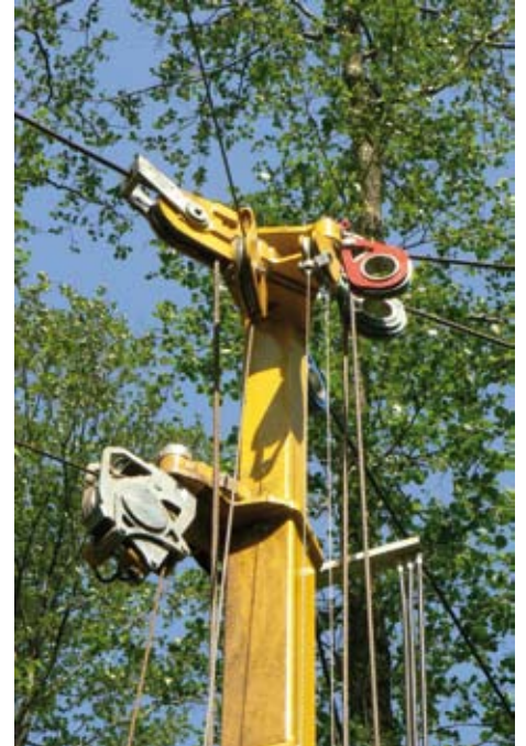
Aan de mast van de hooglier is de draagkabel en vier spankabels verbonden en verder de trekkabel, waarmee de lier aan de draagkabel wordt voortgetrokken.
