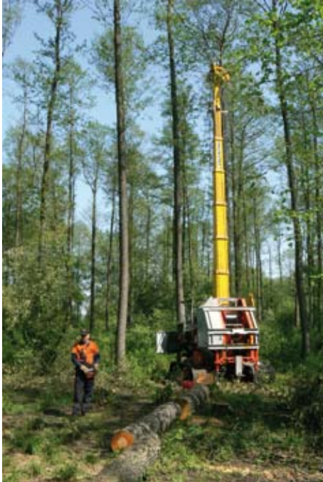
De hooglier is een compacte machine met een telescopische mast tot 13,5 meter hoogte.
